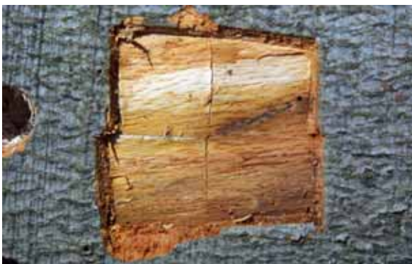
Z°1c: Bast braun trocken, Holz hellbraun trocken, Rinde fest; Geruch: schwach gärig
