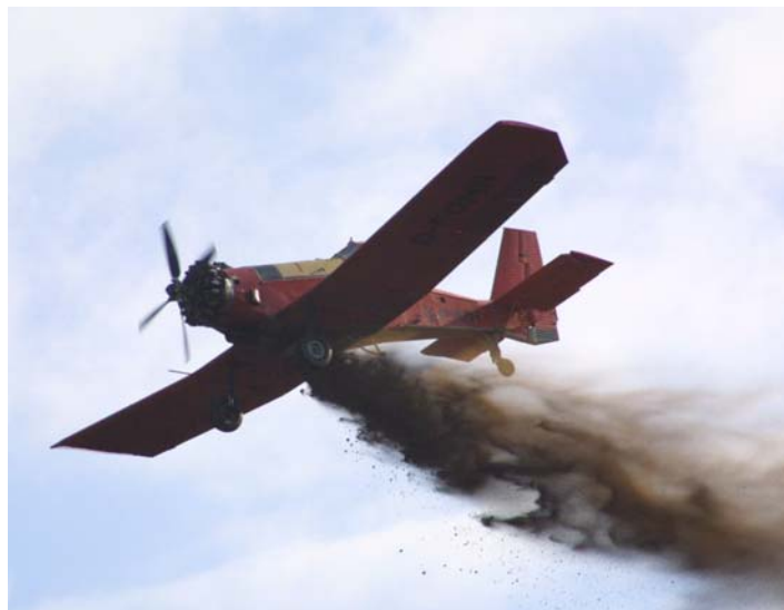
Abb. A1: Luftfahrzeug des Typs M 18 A Dromedar bei der Bodenschutzkalkung Fig. A1: Airplane type M 18 Adromedar during liming
