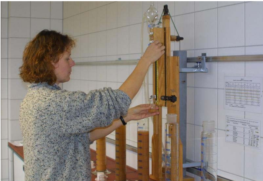
Korngrößenanalyse an Bodenproben im Labor der FAWF. Bodenuntersuchungen sind ein wichtiger Bestandteil von Erhebungen zu den Auswirkungen der Luftschadstoffeinträge und des Klimawandels auf den Wald.
