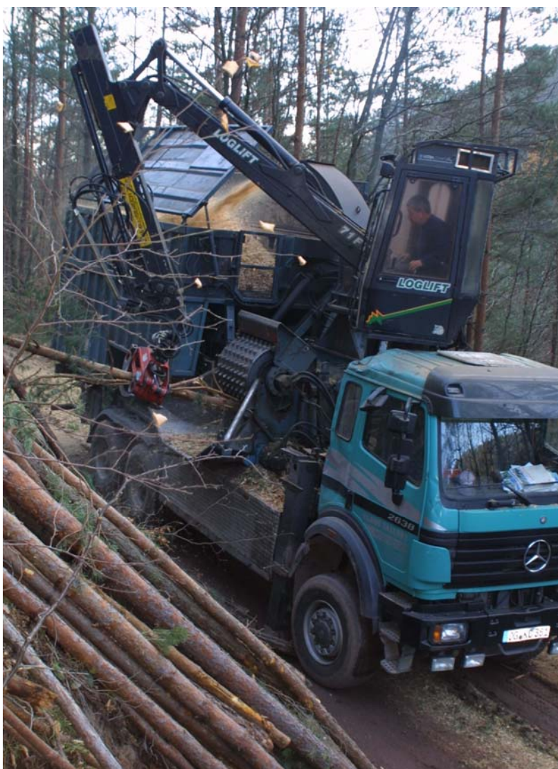
Gewinnung von Hackschnitzeln aus schwachem Kiefernholz zur Verwendung in einem Heizkraftwerk. Die FAWF untersucht nicht nur die technischen und ökonomischen Rahmenbedingungen dieser Nutzung, sondern prüft auch den Einfluss auf die Nachhaltigkeit.
