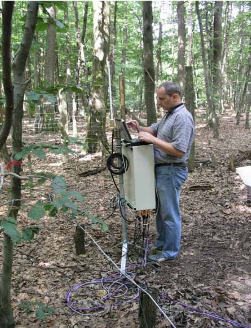
Wie verändert sich der Wasserhaushalt der Waldökosysteme und in welchem Ausmaß entsteht Trockenstress? Diesen Fragen wird wie hier an der Umweltkontrollstation Merzalben im Pfälzerwald mit automatisch registrierenden Feldmesssystemen nachgegangen, die mit Tensiometern, TDR-Sonden, Dendrometern und verschiedenen meteorologischen Messfühlern bestückt sind.
