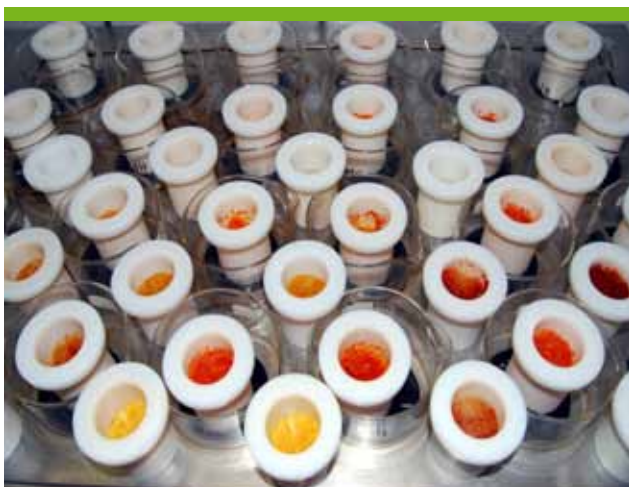
Aufschluss von Pflanzenproben mit konzentrierter Salpetersäure zur Elementbestimmung. Zu sehen sind die Aufschlussgefäße aus Teflon mit eingebrachtem Probenmaterial und Säure bei der Vorreaktion auf einem heißen Wasserbad. Anschließend werden die Gefäße verschlossen und der Aufschluss über Nacht bei 170°C unter Druck zu Ende gebracht Foto: E. Wies
