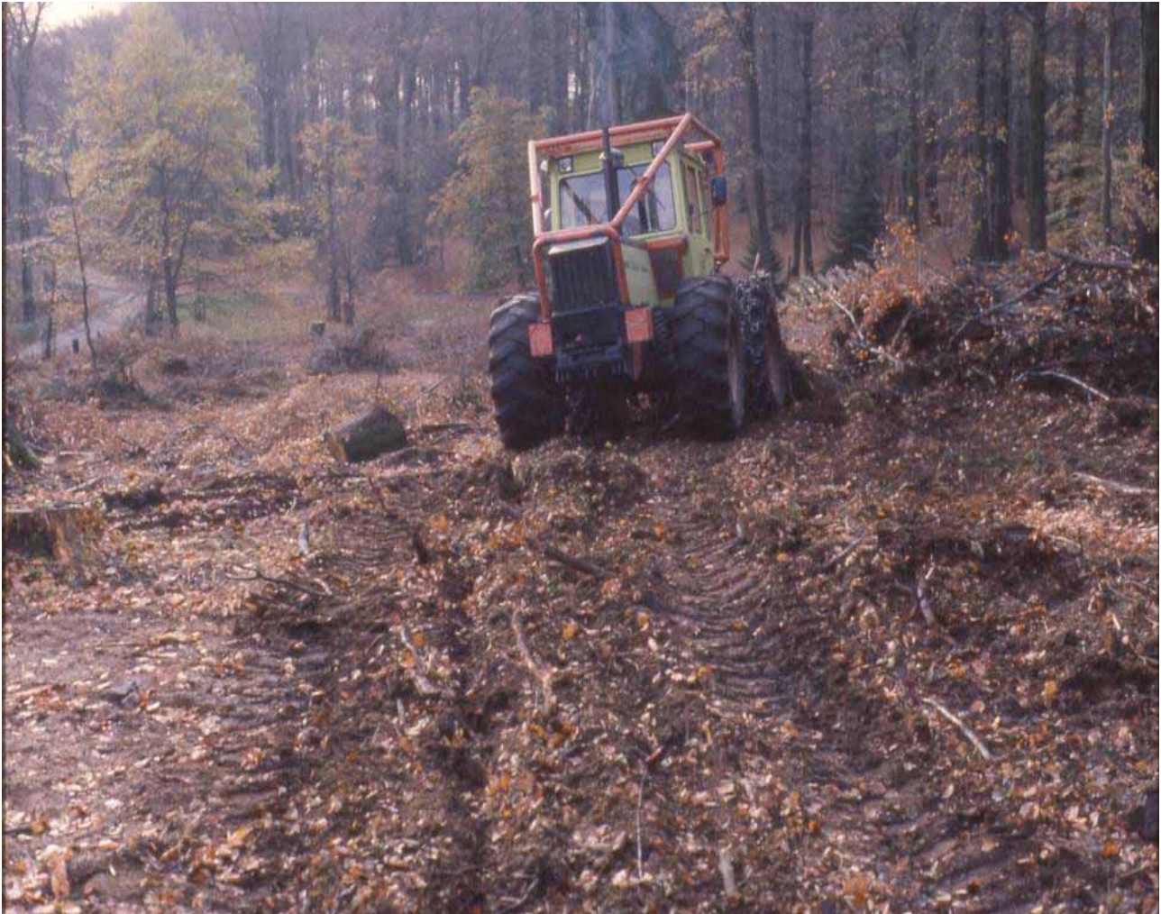
Abb. A6: Universalschlepper mit Räumgerät im Einsatz auf der Versuchsanlage im Forstamt Hinterweidenthal
