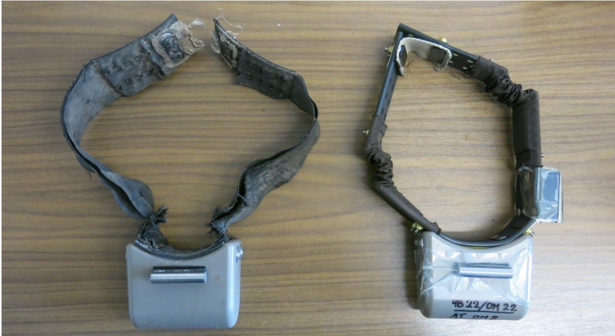
Abbildung 3: Survey-Kälberhalsbänder : Links ein Halsband der 1. Generation nach Gebrauch mit entsprechend starker Ausdehnung und durchtrenntem „Rod-Off“-Band. Rechts ein ungebrauchtes Halsband der 2. Generation mit externem Drop-Off-Element.
