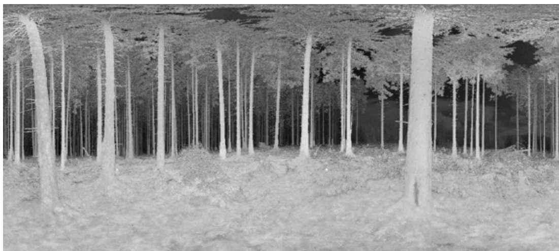
Abbildung 10: 2D-Visualisierung der 3D-Punktwolke, berechnet aus fünf Scannpositionen.
